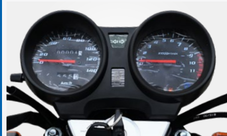
NUEVO TABLERO CON INDICADOR DE MARCHA
